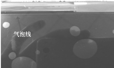
图 4 气泡线不良图 Fig.4 Image of bubble line
